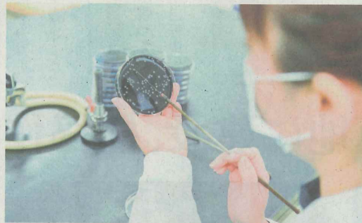
浴槽水のレジオネラの検査は1年に1回以上実施することになっている
